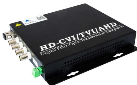
El conversor ACVI transmite la señal de vídeo HDTV/HDCVI/AHD (auto configurable) por una sola fibra a larga distancia (hasta 20km). No precisa ningún tipo de ajuste, facilitando su instalación. Incorpora señalización luminosa indicando la presencia de vídeo en cada canal y si la potencia óptica recibida es la apropiada.
